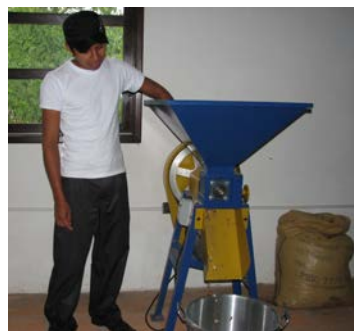
Écailleuse mécanique de noix de macadam favorisant l'augmentation de la productivité
